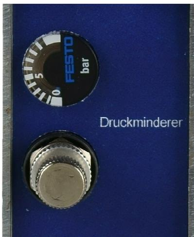
Sobald der Ausgangsdruck unter 0,5 bar sinkt, wird ein Fehler signalisiert..
