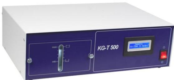
Das Mikroprozessor gesteuerte Kühlgerät KG-T500 dient zum Kühlen von Motorspindeln mit einer Leistung bis maximal 2000W. Es ist nahezu für fast alle Spindeltypen mit Kühlanschlüssen oder Kühlblöcke geeignet.
