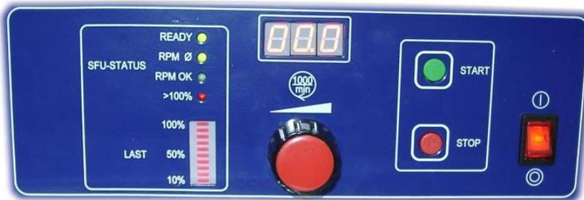
Mit der **START** **STOP** -Taste wird die Spindel gestartet bzw. gestoppt. Die aktuelle Drehzahl wird auf der 7-Segment Anzeige ausgegeben.
