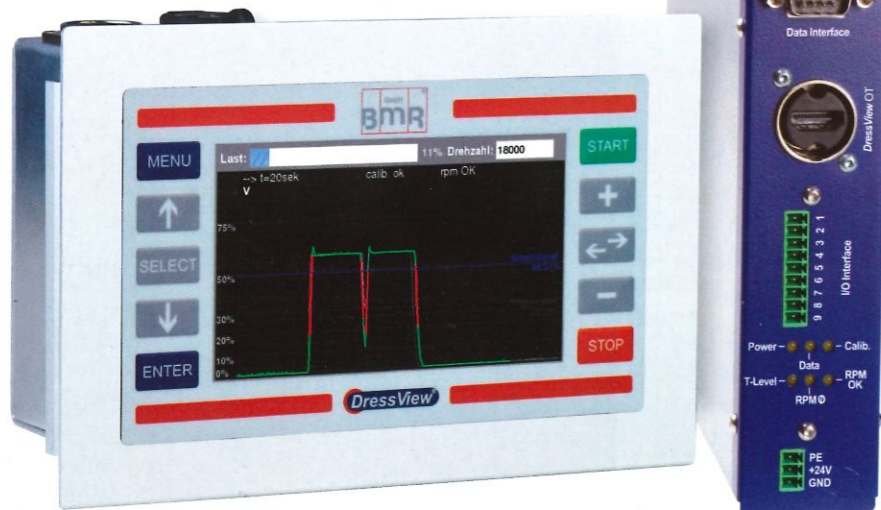
Bild 2: MotorView System: Erfassungs-Elektronik zusammen mit Display Einheit für Festeinbau im Bedienpanel. Display in Panel-Mount-Unit (PMU) Ausführung
